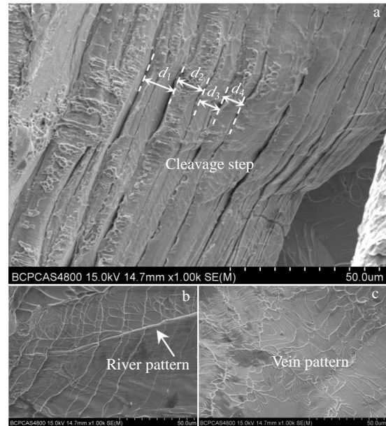
图 8 Ti 45 Zr 35 Cu 5 Ni 15 块体非晶合金液氮温度条件下动态压缩断口形貌
