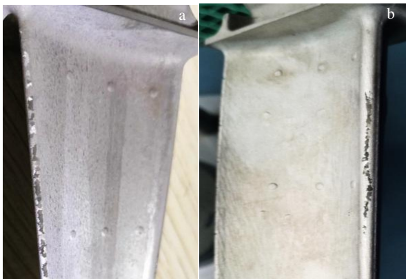
图 3 单晶叶片铸件排气边和进气边上的雀斑缺陷
