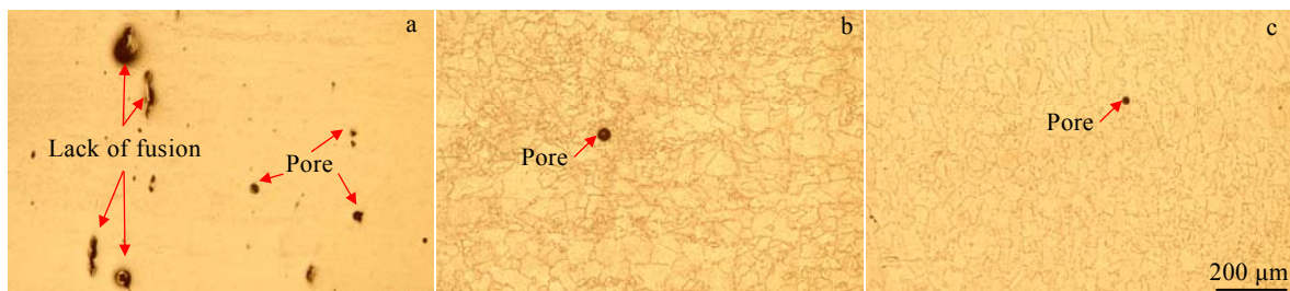
图 8 样品的缺陷分布图
