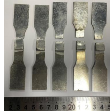
图 7 复合钎料钎焊接头断裂位置照片
