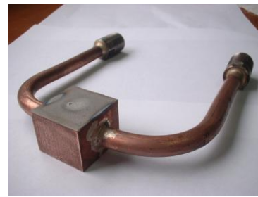
图 3 钨/铜热负荷性能测试模块
