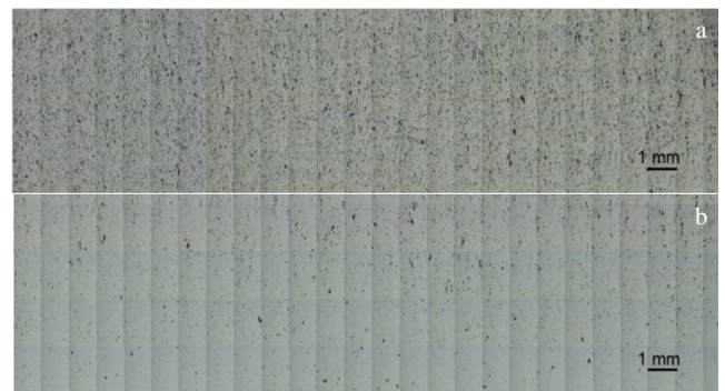
图 14 不同喷涂气体的 CSAM TC4 横截面微观组织
