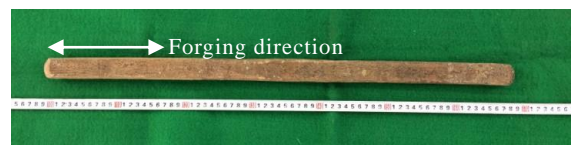
图 2 离心锭锻造后的 TMW 合金试样实物图
