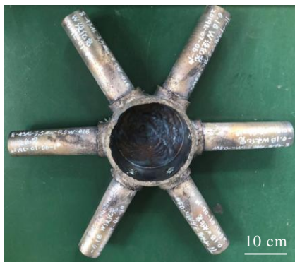
图 1 制备的离心锭实物图
