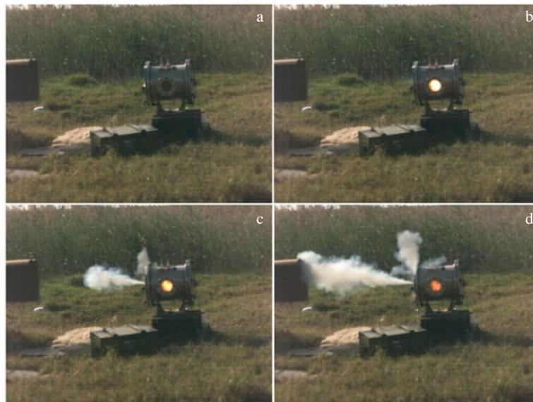
图 8 W(Zr<sub>20</sub>)-Zn<sub>30</sub> 合金在冲击反应过程的高速摄像照片
