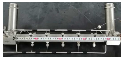
图 5 安装测量热电偶后的换热单元试验件
