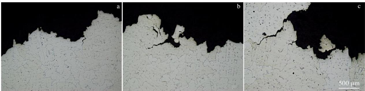
图 7 试样 Z4、Z5 和 Z6 断口附近纵剖面 OM 组织
