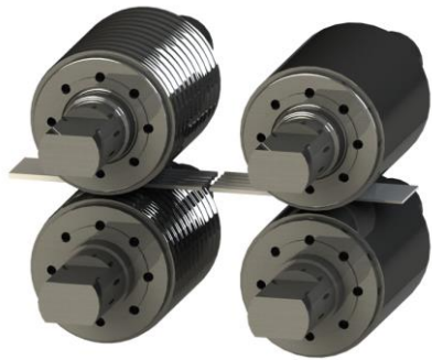
图 1 纵波轧制+平辊轧制示意图
