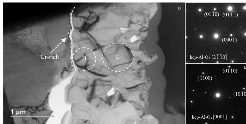
图13 0Y合金在1200 °C高温蒸汽中恒温氧化2 h的氧化膜截面显微组织分析
