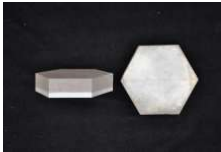
图 1 陶瓷/合金钢层状复合材料六边形制品
