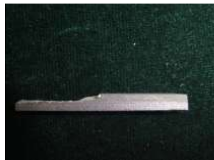
图 7 复合材料三点弯曲强度测试后的失效样品
