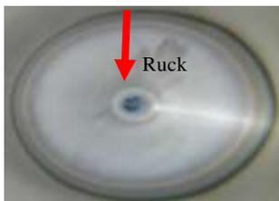
图 3 采用正旋组合轨迹收口后的内衬内表面
