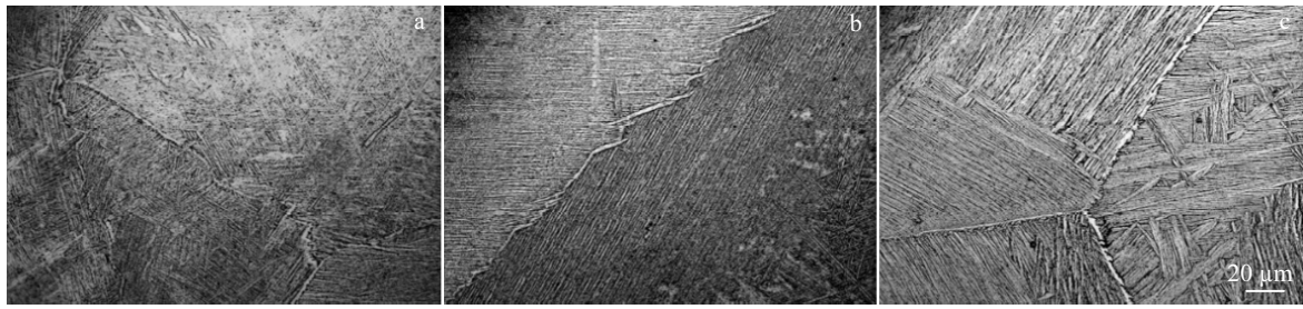
图 2 相变点以上固溶温度的 TC4-DT 合金金相组织
