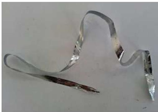
图 1 快速凝固 Ag-Cu-Ge 钎料薄带
