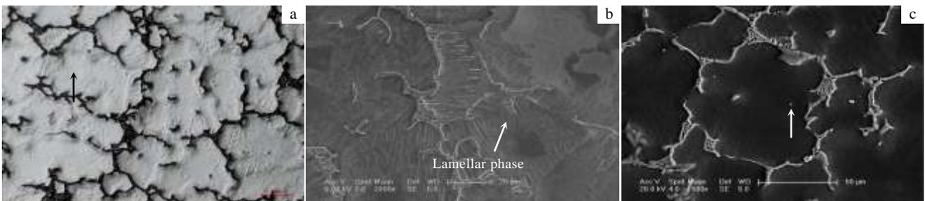
图 1 合金的铸造态光学以及 SEM 照片
