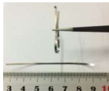
图 1 W 17.9 Ni 65.6 B 13.5 V 3 薄带形貌
