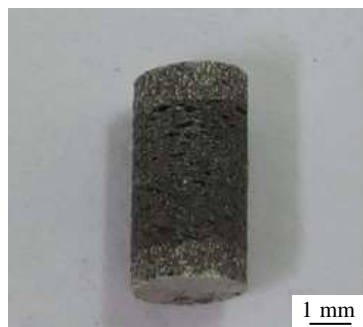
图 2 泡沫铝夹芯板的 SR-CT 测试样品
