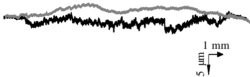
图 7 Ti-6Al-4V 合金空化腐蚀 900 min 后的表面轮廓
