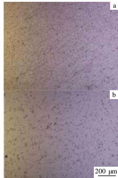
图 3 原始挤压态铝合金 6063 的微观组织
