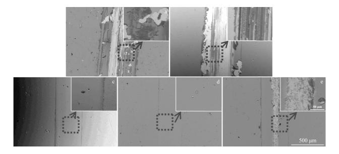
Fig. 8 Grinding crack of CrN films at different nitrogen flow: (a) 15 cm<sup>3</sup>/min, (b) 20 cm<sup>3</sup>/min, (c) 25 cm<sup>3</sup>/min, (d) 30 cm<sup>3</sup>/min, and (e) 35 cm<sup>3</sup>/min
