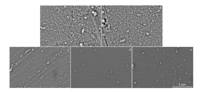
Fig. 1 Surface morphologies of CrN films at different nitrogen flow: (a) 15 cm<sup>3</sup>/min, (b) 20 cm<sup>3</sup>/min, (c) 25 cm<sup>3</sup>/min, (d) 30 cm<sup>3</sup>/min, and (e) 35 cm<sup>3</sup>/min
