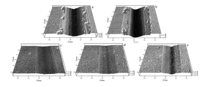
Fig. 9 3D morphologies of CrN films at different nitrogen flow: (a) 15 cm<sup>3</sup>/min, (b) 20 cm<sup>3</sup>/min, (c) 25 cm<sup>3</sup>/min, (d) 30 cm<sup>3</sup>/min, and (e) 35 cm<sup>3</sup>/min
