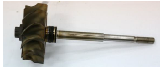
图 3 耐久性考核后的 TiAl 涡轮转轴
