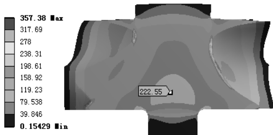
图 7 标定转速下涡轮轮毂的等效应力云图
