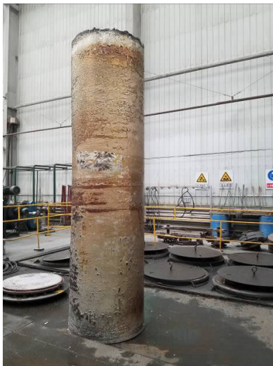
图 4 12 t 级 Ti80 合金铸锭 Fig.4 12 t ingot of Ti80 alloy
