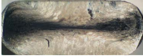
图7 Ti-1300 合金加工失稳区对应的低倍组织
