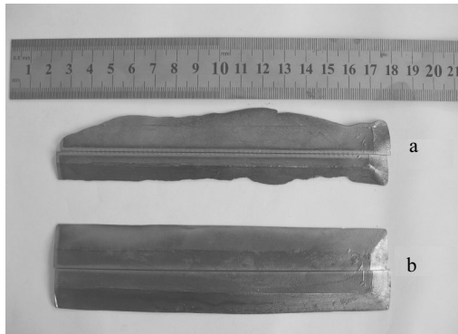
图 6 立式离心场下钛合金薄壁件不同转速下的成形状态
