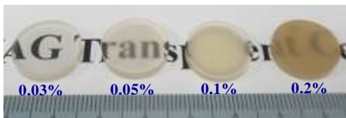
图 2 添加不同含量 MgO 的 YAG 透明陶瓷照片 Fig.2 Photos of YAG transparent ceramics with different MgO contents
