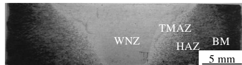
图 2 试样横截面腐蚀形貌
