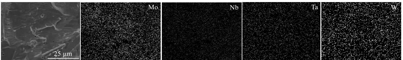
图 4 MoNbTaW 难熔高熵合金 (No.3) 的 EDS 元素面分布图
