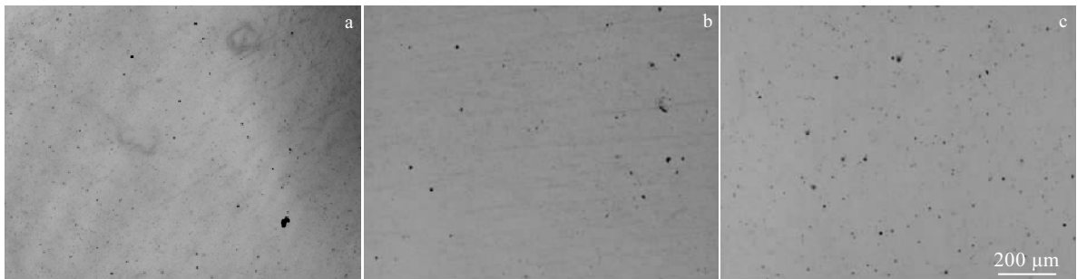
图 5 不同粒径粉末成型零件的 OM 形貌
