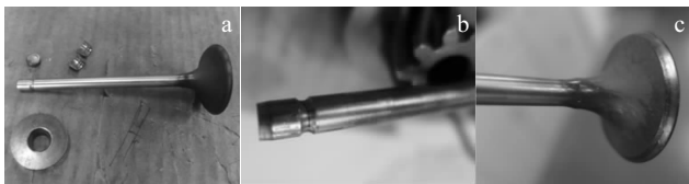
图 6 钛气门装机试验后的宏观照片
