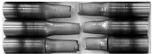
图 2 部分断裂的空心圆管试件
