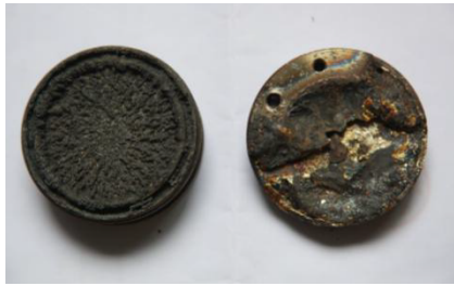
图 4 TC4 试样燃烧后形态 (左为转子件, 右为静子件)
