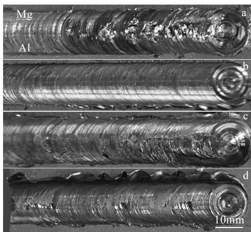
图 1 铝合金置于前进侧, 前进速度 40 mm/min 时接头宏观形貌图
