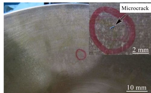
图 3 经 290~330 ^{\circ}\text{C} 旋压变形后表面微裂纹形貌
