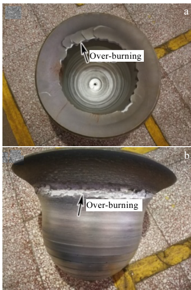
图 5 经 480~500 °C 旋压变形后“过烧”失稳形貌
