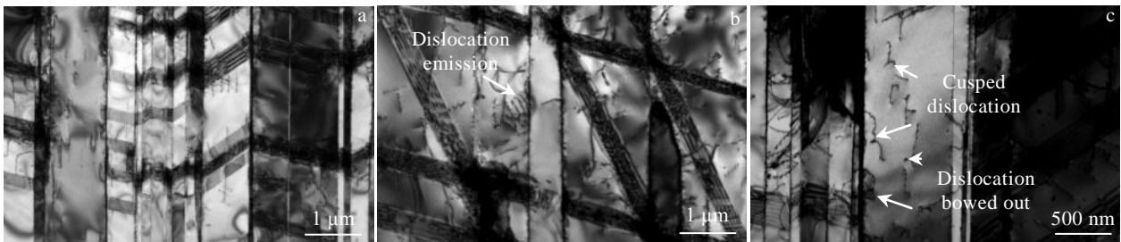
图 7 TAC2 合金在 760 °C, 138 MPa 条件下蠕变变形 10 h 的微观结构照片
