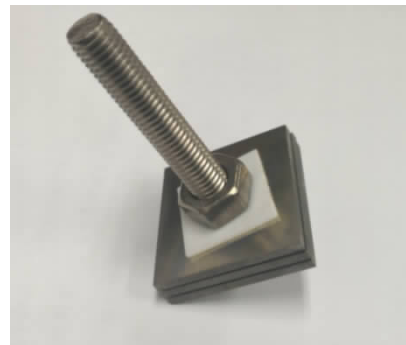
图 2 钛合金缝隙腐蚀试样
