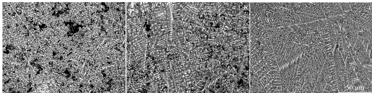
图 2 真空电弧炉熔炼 1 次, 3 次, 5 次的 Nd(FeTiNb) 12 铸锭光学显微镜微观形貌
