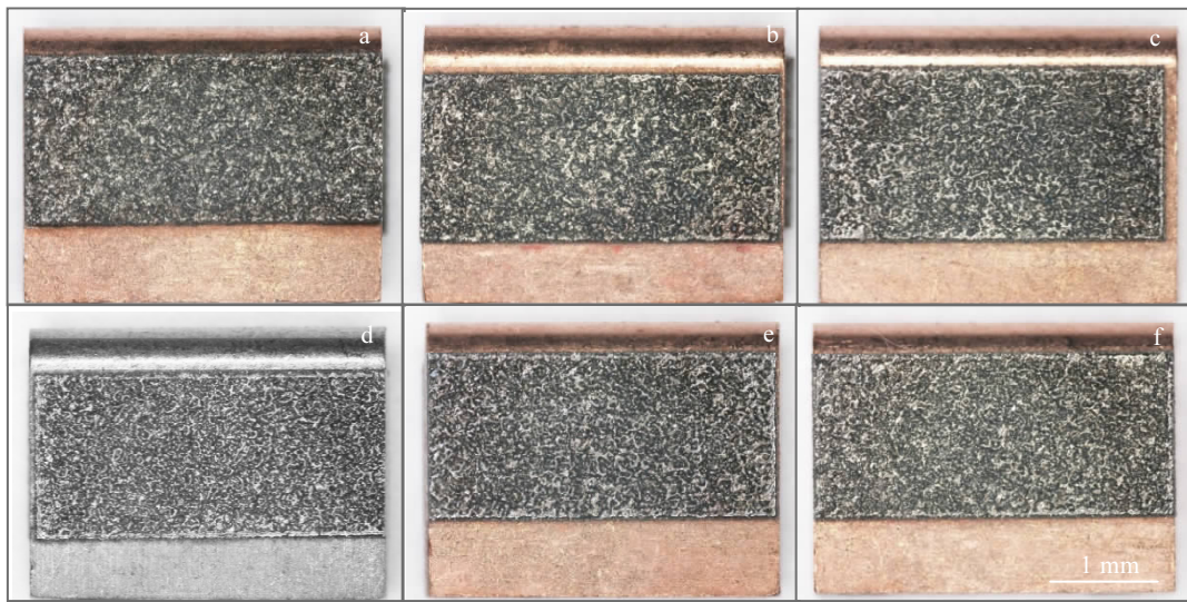
图 3 SLM 成形 Kanthal 涂层表面形貌
