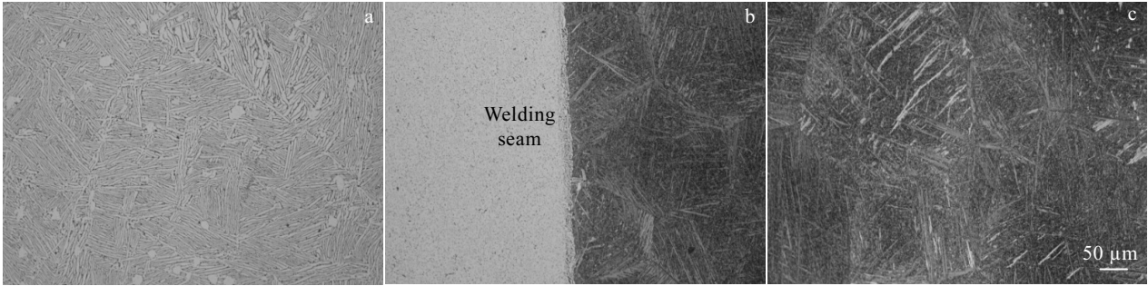
图 6 IMI834/Ti6246 双钛合金缩比盘焊后接头区域的显微组织
