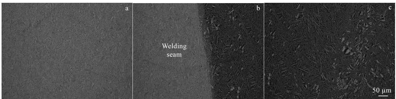
图 7 等温变形后 IMI834/Ti6246 双钛合金缩比盘接头区域显微组织
