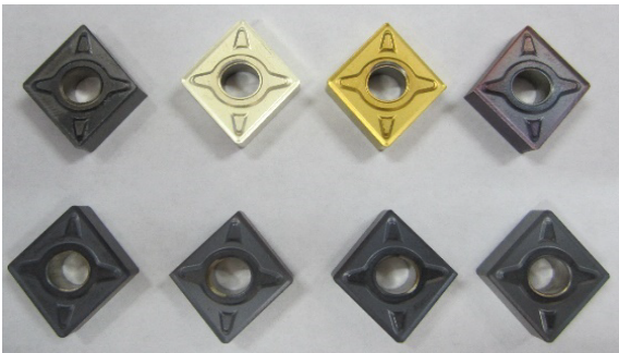
图 8 应用热、动力学计算模拟设计制造的工业化硬质合金
