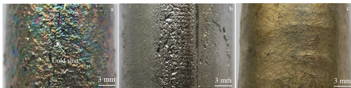
图3 Ti5Al2.5Sn ELI 钛合金铸态试样表面局部形貌
