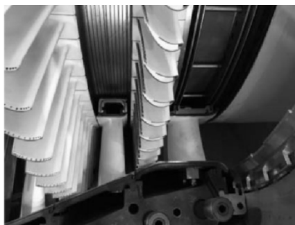
图 1 燃气轮机透平动、静叶片
