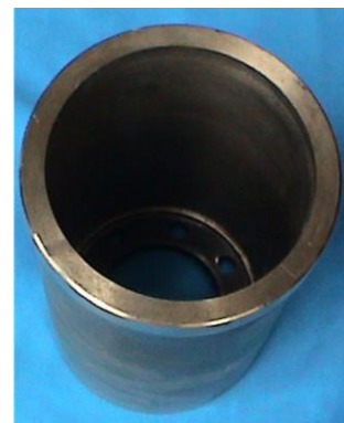
图 11 冷旋 U-6.5Nb 合金管件
