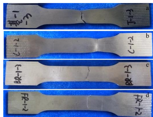
图 4 室温拉伸试样断裂后整体形貌
