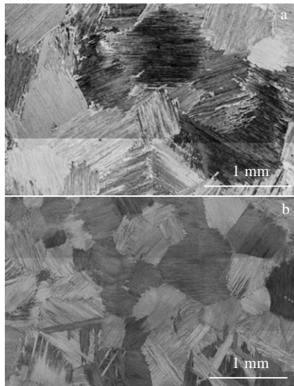
图 7 不同冷速获得的 Ti-47Al-2Cr-2Nb 合金全片层组织
