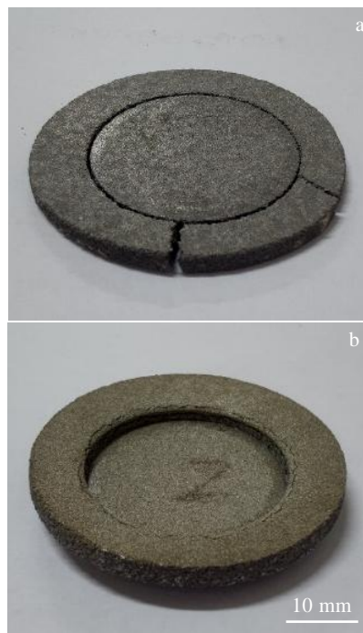
图 8 不同温度下多孔 Inconel 625 合金剪切后试样
