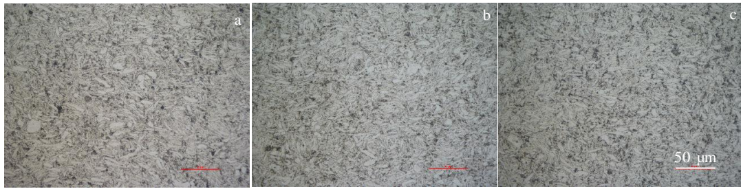
图 4 真空中不同温度烧结的复合材料的金相组织
