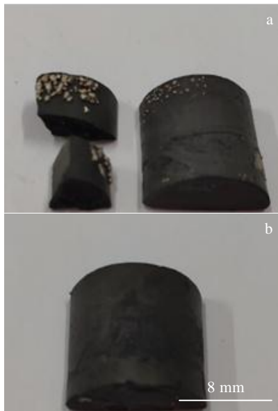
图 3 复合粉末坯体在非真空和真空下烧结试样
