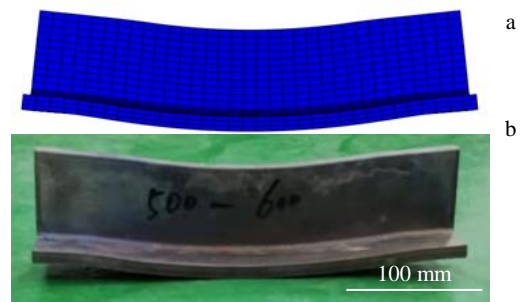
图 12 模拟和实验回弹后的型材
